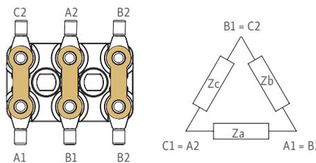
Motore doppia velocità, singolo avvolgimento Δ/YY | Two speed Δ/YY, single winding
