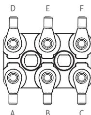
La tensione di alimentazione indicata in targhetta dev'essere fornita tra A,B e C nel caso si volesse adoperare la velocità bassa. La tensione di alimentazione indicata in targhetta dev'essere fornita tra D,E e F nel caso si volesse adoperare la velocità alta. | The nameplate voltage has to be supplied between A,B and C in case of low speed. The nameplate voltage has to be supplied between D, E and F in case of high speed.
